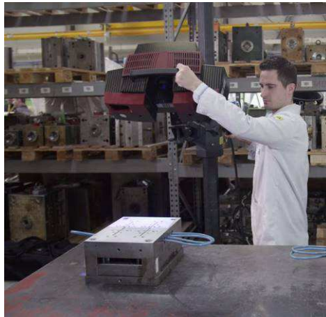
4. kép Helyszíni 3D felületdigitalizálás
